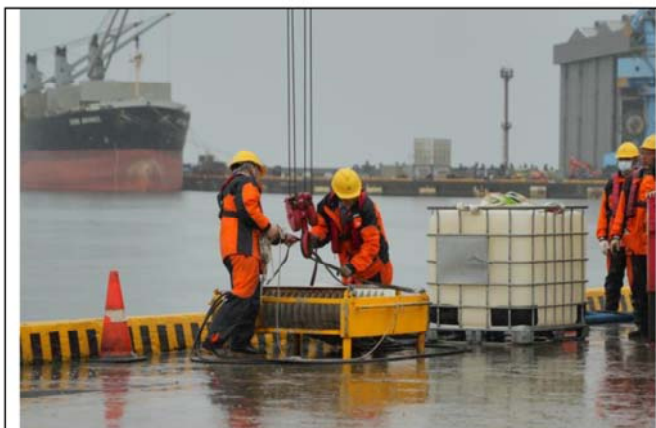
中油公司以汲油器進行海上廢油污回收
